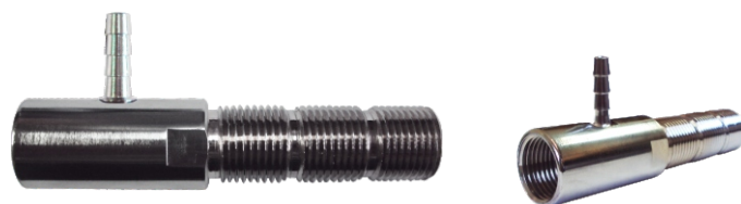
ADAPTADOR PARA FILTRO DE BANCADA ESPIÇA CODIGO: MODELO: NCM COD. DE BARRAS 734 SAIDA MANG. 1/4 ESPIÇA 84818011 7899497807345 735 SAIDA MANG. 1/8 ESPIÇA 84818011 7899497807352 736 SAIDA MANG. 5/16 ESPIÇA 84818011 7899497807369
